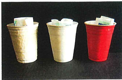
▲実験開始0分。一般的結露防止塗料塗布、ノン結露塗布、無塗布 (写真左から)
