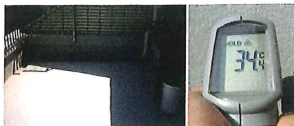
▲ガイナ塗布後のベランダ表面温度は、34.4℃ (外気温34℃) と、大幅に温度が低下。
